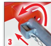
Dispositif d'attelage "**Sécurité**" breveté. Homologué par l'UTAC suivant le
