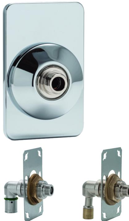
Platine de WC modèle R-Fix® de marque Riquier® avec raccords pour PER visible (raccords à sertir ou à glissement), en sortie mâle 3/8. (Modèle coudé, pour PER 12 ou 16 au choix). Disposant d'un cache de finition chromé. Livré avec bouchon d'obturation pour les travaux.
